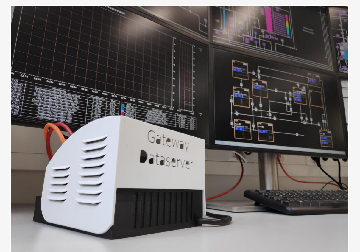
Versuchsanlage THERESA und das neu entwickelte Gateway für die Kombination von Experiment und Simulation
